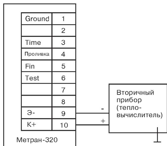
Рис. 1. Схема подключения расходомера 320 к вторичному прибору.
