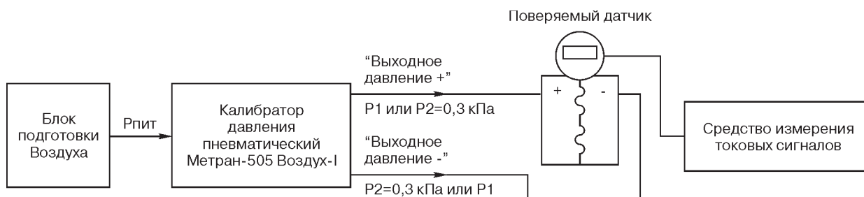
Рис.5. Схема подключения калибратора 505 Воздух-I при поверке датчиков разности давлений с использованием БОД.
