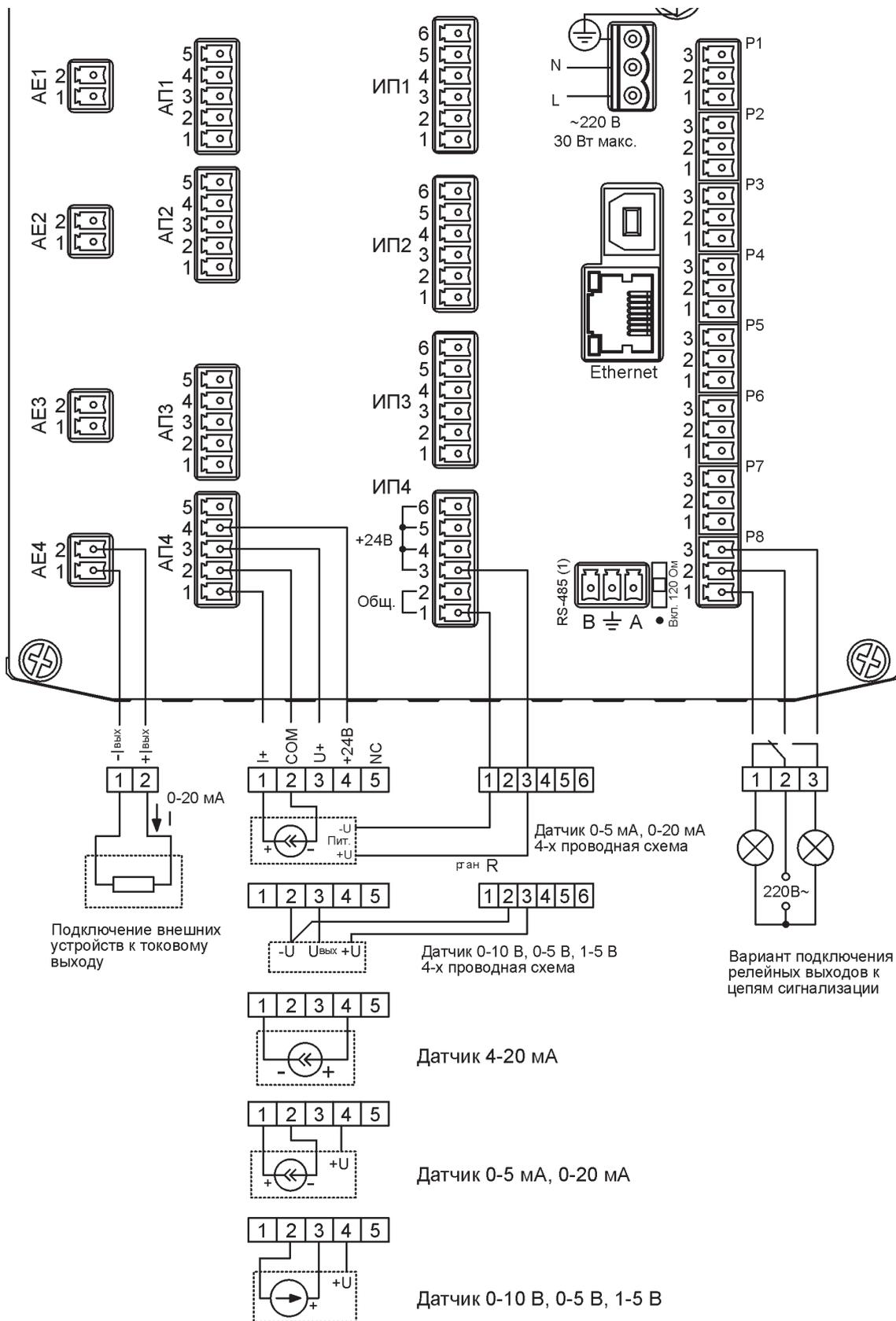
Рис. 14. Схема подключения каналов АП, АЕ, ИП, Р, С.
