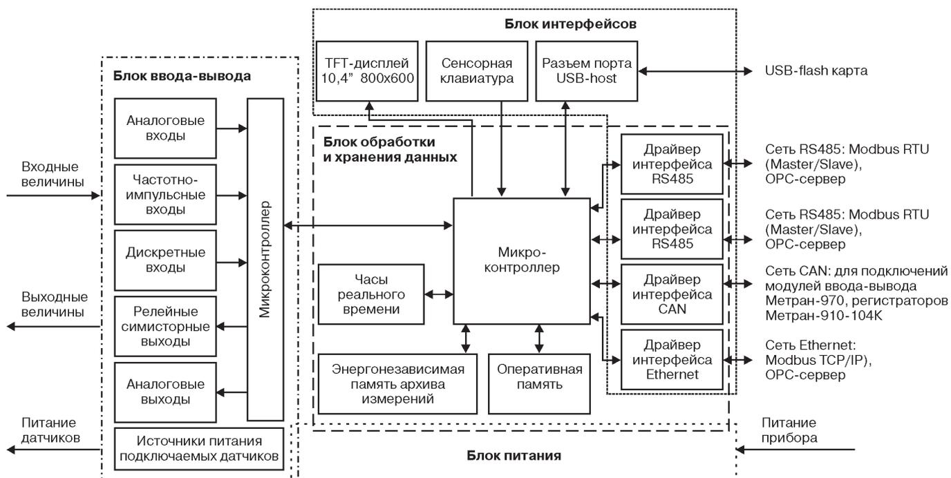
**Рис. 1. Структурная схема регистратора модели 910-104К.**
