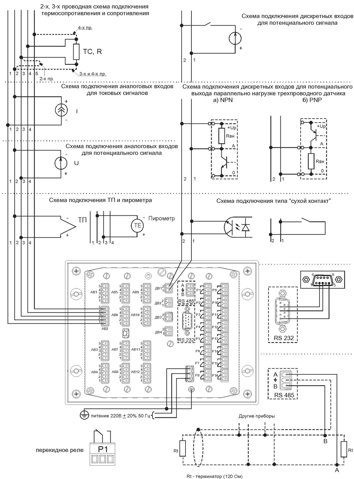
**Рис. 12. Схемы подключения регистратора исполнения 2.**
