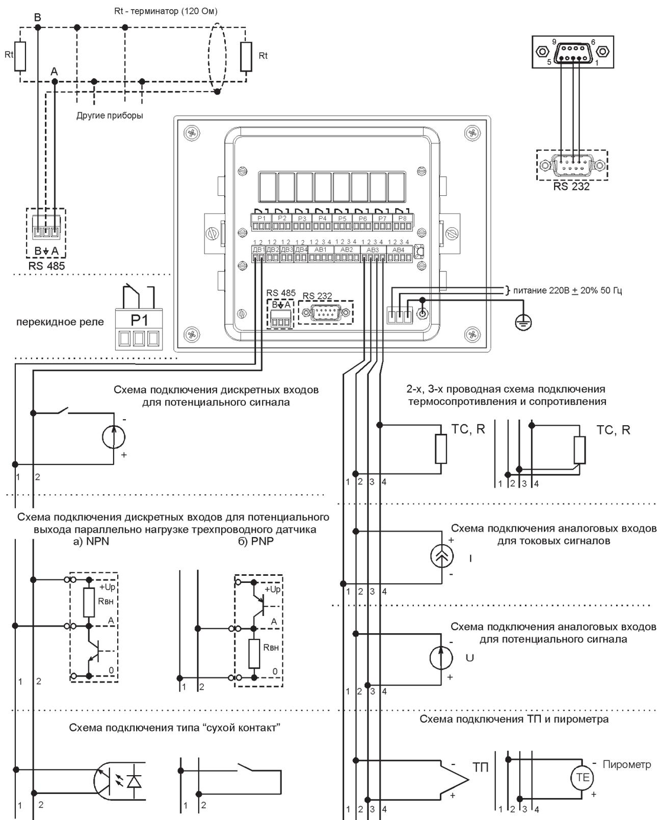
Рис. 11. Схемы подключения регистратора исполнения 1.
