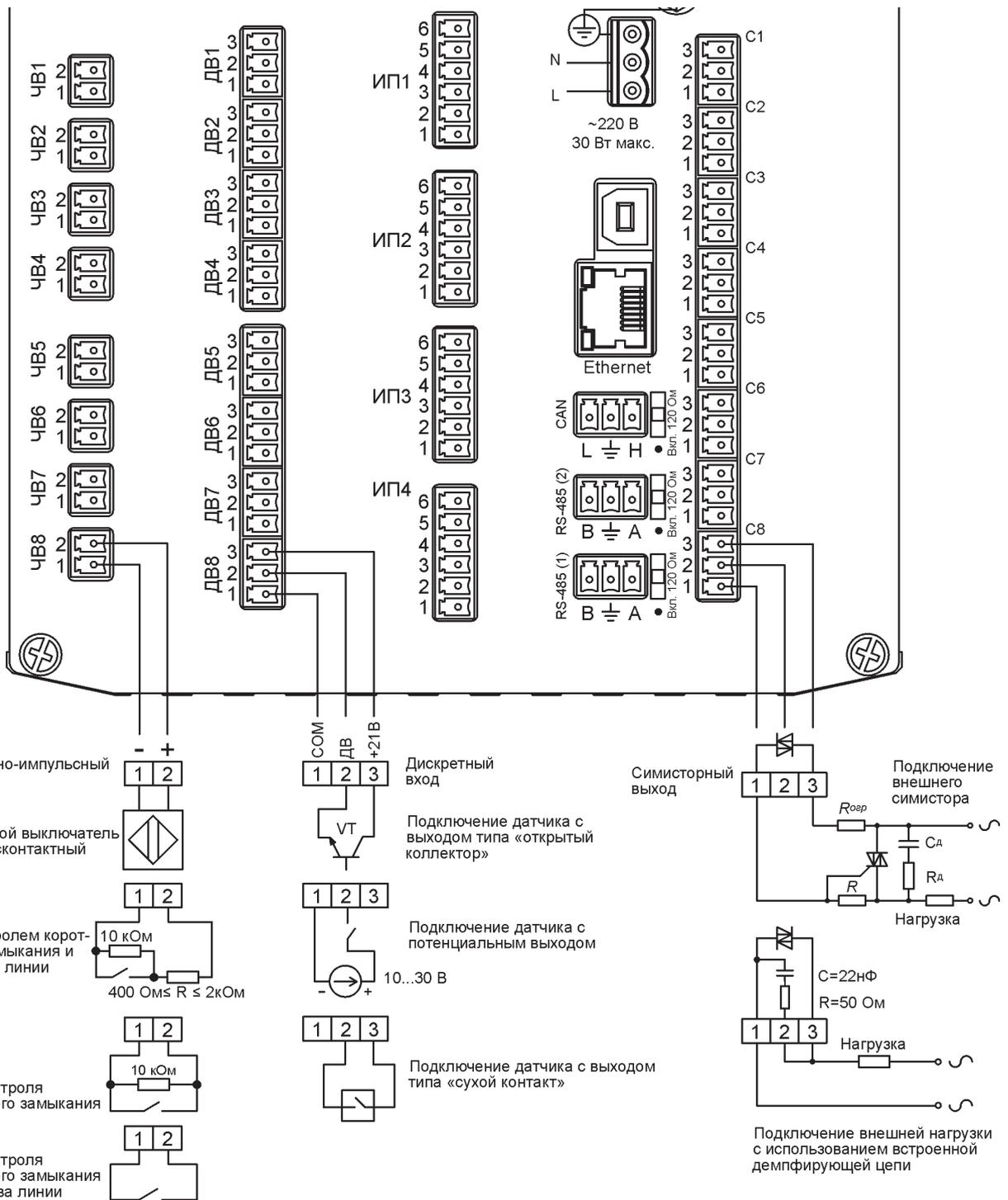
Рис. 15. Схема подключения дискретных/частотных (ДВ/ЧВ) входов и симисторных (С) выходов.
